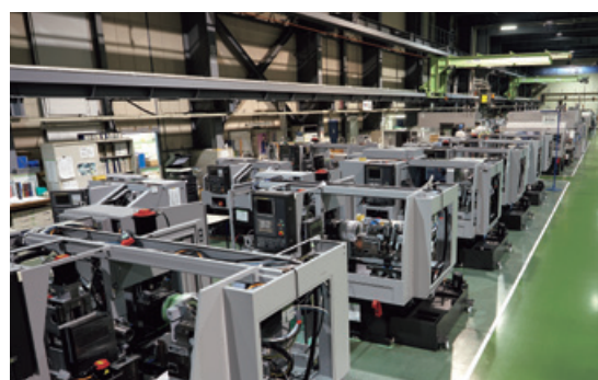
主軸移動型自動旋盤の生産ライン
