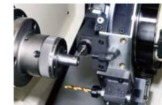
旋盤加工及びマシニング加工を1台でこなす工程集約形の複合加工機。旋盤とマシニングセンタ2台で加工していたものを1台に集約、段取り替えなしで複数ワークを加工などの高度な要求にお応えします。
